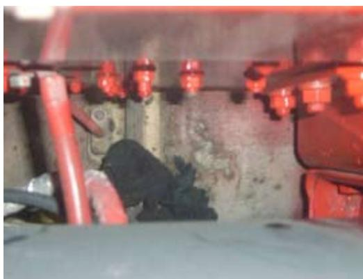
写真7 排気管上の炭化タオル(再現)
