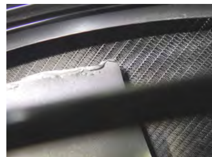
(4) 損傷したファン
