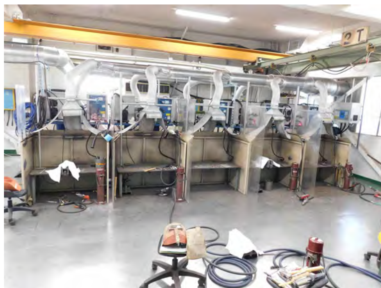
写真1 溶接機及び作業台
