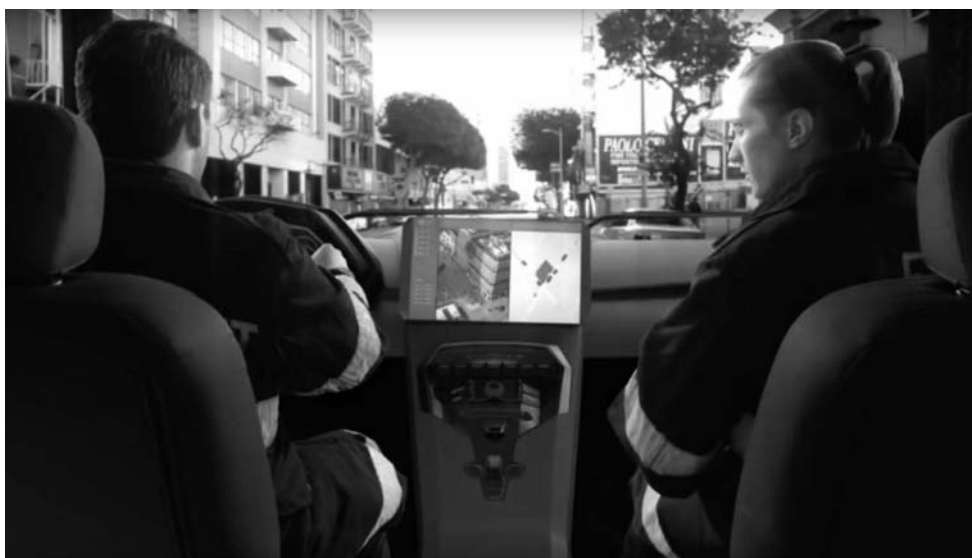
AI 搭載の消防車内ディスプレイにドローンからの映像と先着隊の配置状況が表示されている（出典：Youtube）
