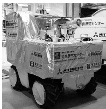
写真3 放水砲ロボット一次試作機の概観
