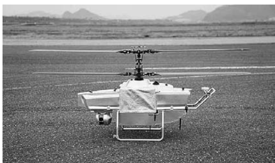
写真1 飛行型偵察・監視ロボット一次試作機の概観
