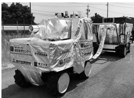
放水砲及びホース延長ロボット
