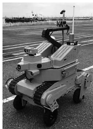
写真2 走行型偵察・監視ロボット一次試作機の概観
