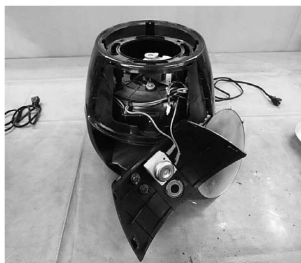
写真No.12 操作パネル部及び天板展開後の状況
