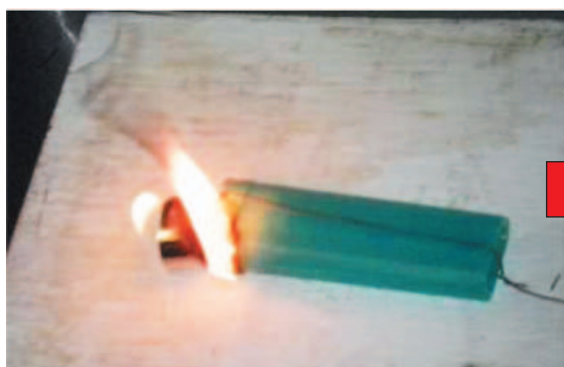
写真No.6 着火約1分30秒後 着火操作部の本体樹脂部分が溶融し発火
