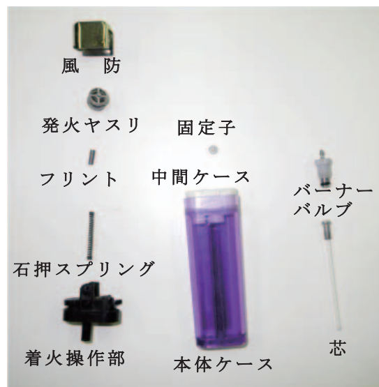
写真No.3 焼損したガスライターと同等品を分解する
