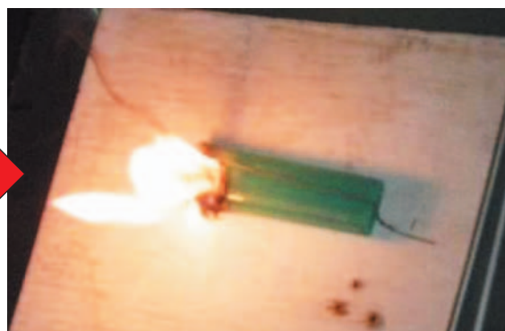
写真No.7 着火約2分40秒後 本体ケース内の燃料ガスが噴出
