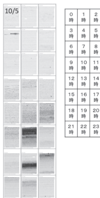
図3 土石流と判断できた震動。10月5日16時台に記録された震幅の大きな震動は土石流が火口付近から谷に沿って流れたものと推測される。
