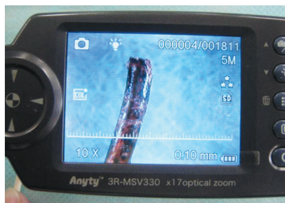
写真14 デジタル顕微鏡で軟銅線を撮影
