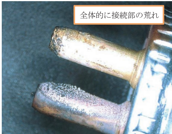
写真8 焼損側の蛍光管口金両面の状況
