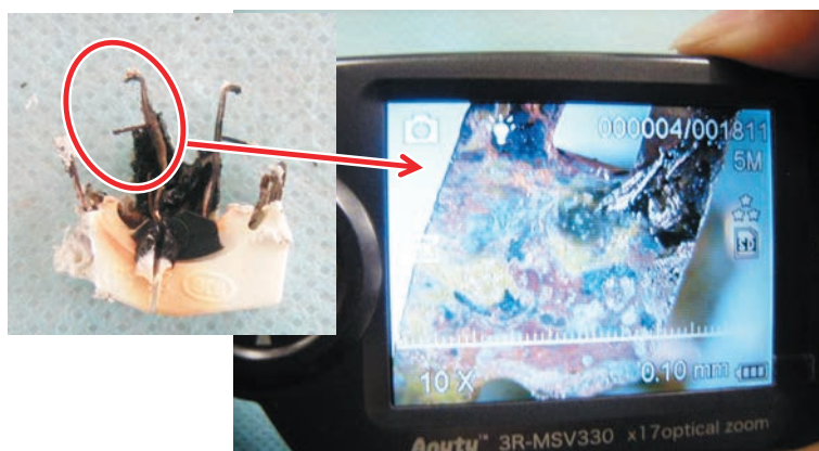
写真15 デジタル顕微鏡で受け板を撮影
