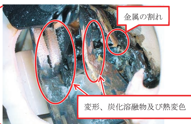
写真7 焼けているソケットの状況
