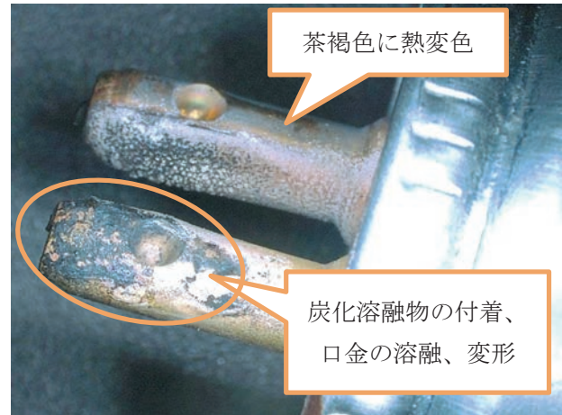
写真9 焼損側の蛍光管口金両面の状況
