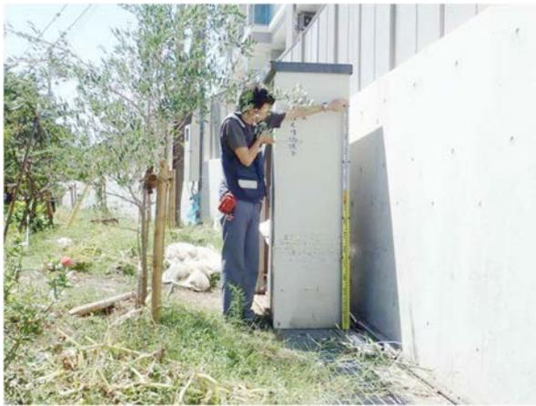
図11 サンシャインワーフ神戸の北側の防潮堤における浸水痕跡
