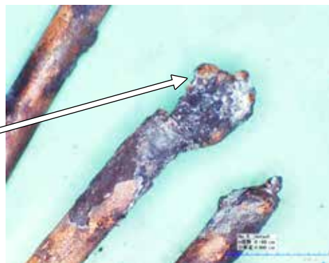
【写真13】溶断箇所（×20倍）
