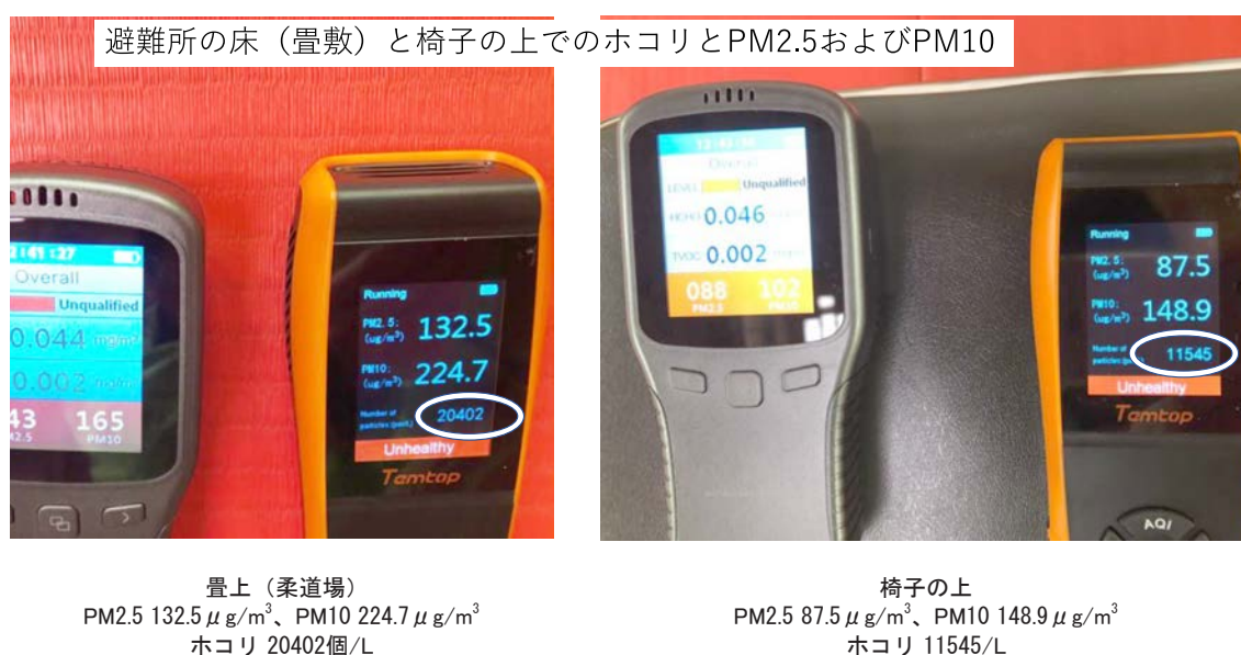
（図1）令和元年台風19号いわき市避難所での粒子濃度計測（2019.11.24）
