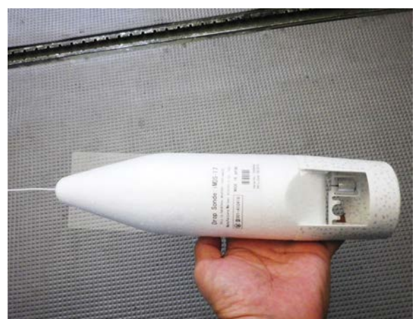
図3 名古屋大学宇宙地球環境研究所と明星電気株式会社で新しく開発したドロップゾンデ (IMDS-17) の本体。小型軽量でパラシュートを使用しない点の特長である。本体はトウモロコシを原料とする生分解性素材でできている。
