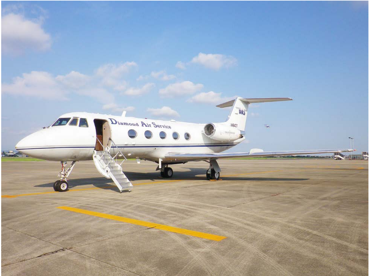
図1 台風の航空機観測に使用するジェット機、ガルフストリームⅡ。主翼付け根付近にドロップゾンデの投下装置がつきだしているのが見える。ダイヤモンドエアサービス株式会社所有。県営名古屋空港にて著者撮影。
