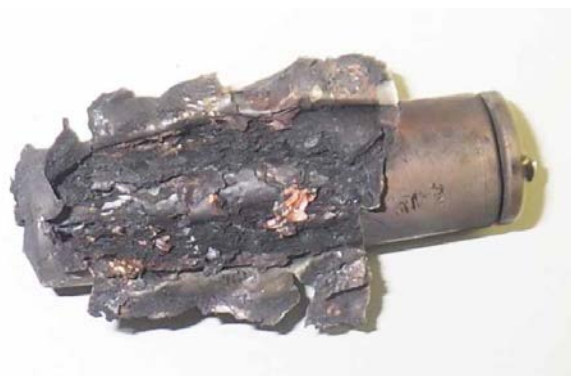
写真15 内部が露出したリチウムイオン電池
