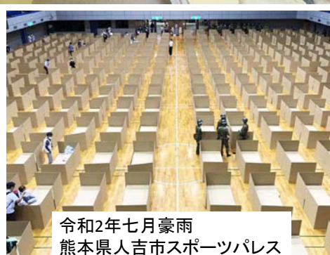
図8: 段ボール製簡易ベッド(190 x 90 x 35cm)。全国の段ボール工場で製造可能となるよう、開発したJパックス(株)から仕様が公開されている。
