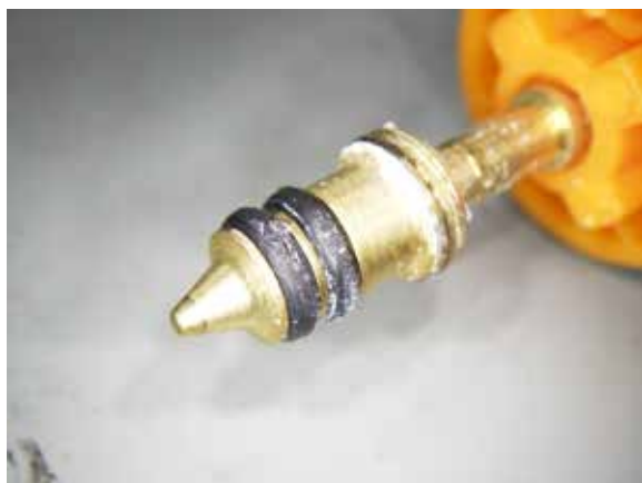
写真10 器具栓内部のOリング
