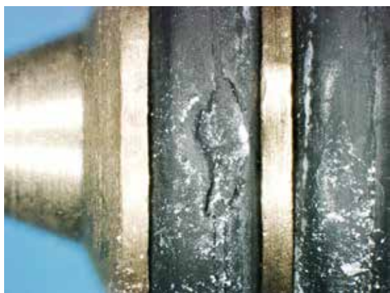
写真11 Oリングの損傷状況
