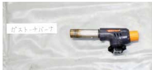
写真 8 焼損したトーチバーナ
