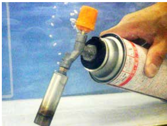
写真9 漏洩試験の状況
