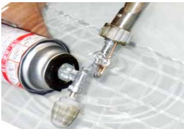
写真4 漏洩試験の状況
