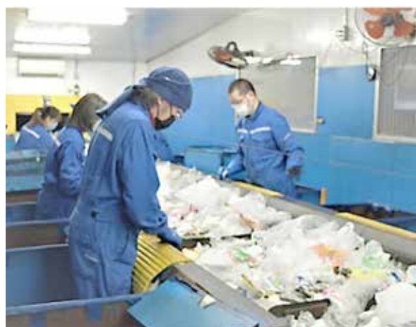
図4 プラスチック製容器包装廃棄物の手選別の様子 17
