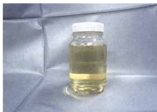
写真20：新品の作動油の状況
