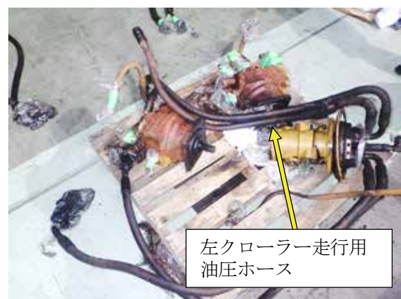
写真9：油圧ホースの状況
