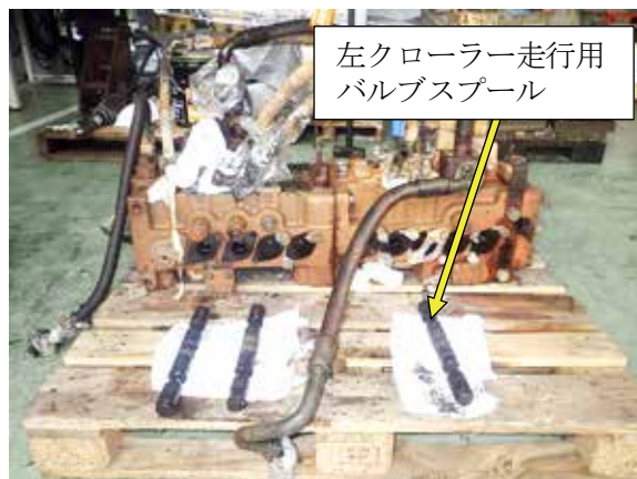
写真12：コントロールバルブの状況
