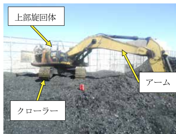
写真3：上部旋回体の状況
