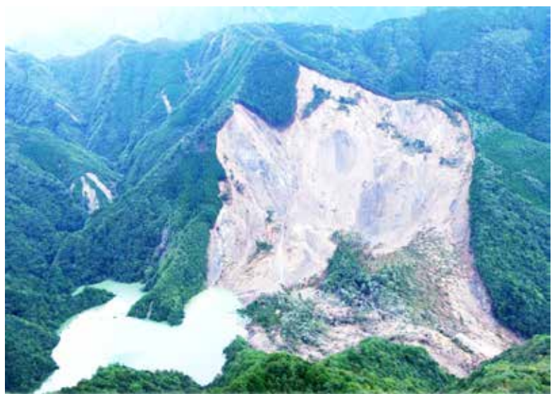
写真-5 2012年9月に台風12号により発生した深層崩壊と河道閉塞(天然ダム) 奈良県十津川村 (国土交通省提供)
