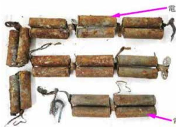
【写真7 焼損した電池セル】
