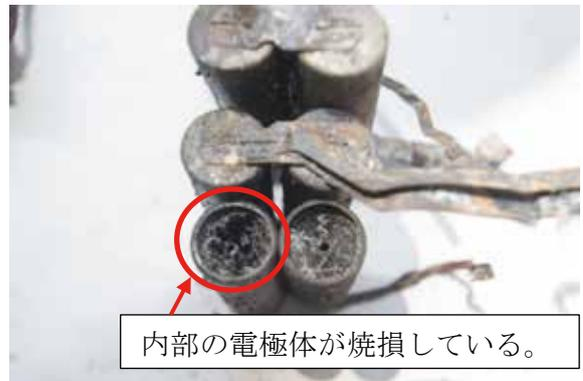
【写真6 焼損した電池セル】
