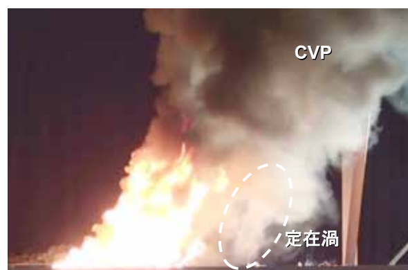
図8 CVPの最下部である可能性が高い「火災風下の定在渦」
