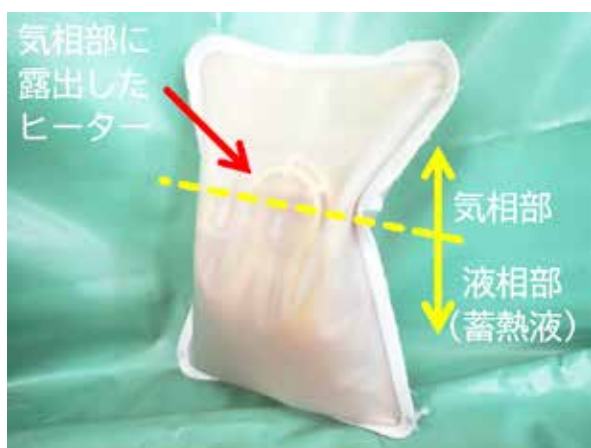
【写真16 気相部に露出したヒーター】
