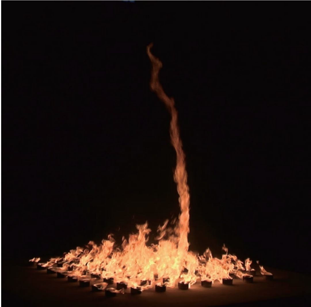
実験で再現した火柱状の火災旋風
