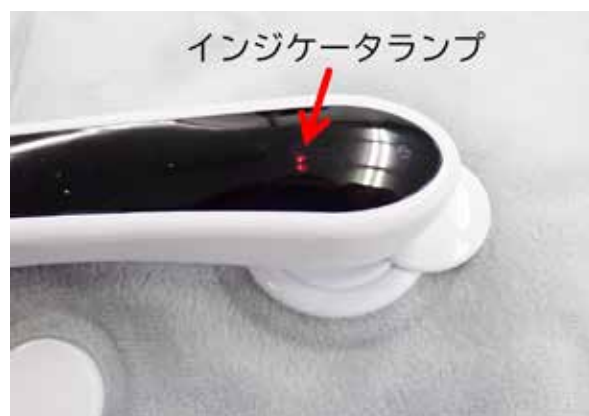
【写真8 蓄熱時のインジケータの点灯】
