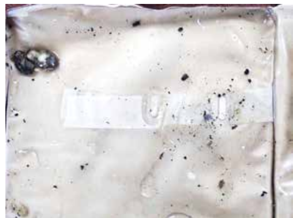
【写真14 固定バンド破断状況】
