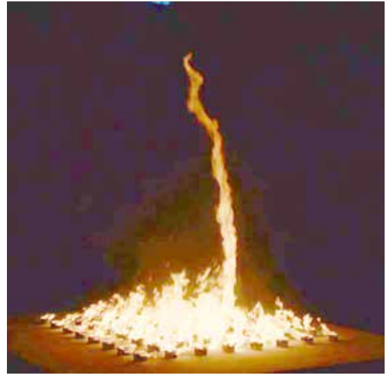
図1 実験で再現した火柱状の火災旋風
