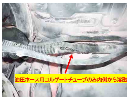
写真3 各コルゲートチューブの状況
