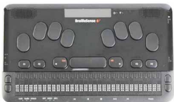
図2 ブレイルセンスシックス（EXTRA 社、点字携帯端末の一例）。画面の下が点字ディスプレイで、8 個組の白い点が昇降して一文字ずつ表示する。中央の6つのボタンを点字の各点に見立てて入力する。
