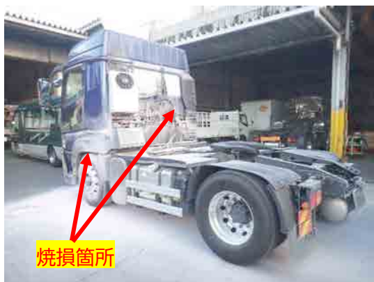
写真1 トラクターに確認できる2箇所の焼損箇所
