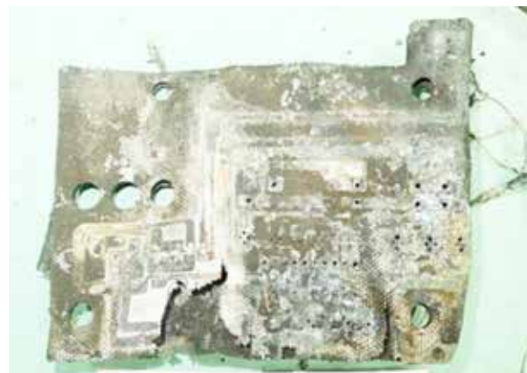
【写真18 焼損品：操作基板】
