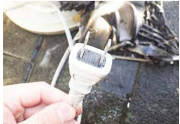
【写真2 焼損品：差し刃】
