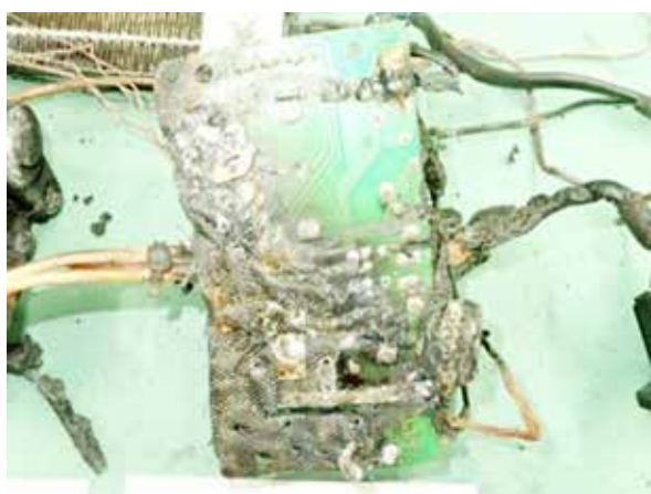
【写真20 焼損品：電源基板】
