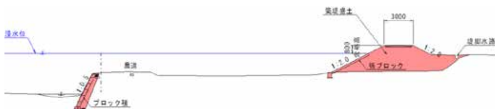
図-3 輪中堤計画断面図
