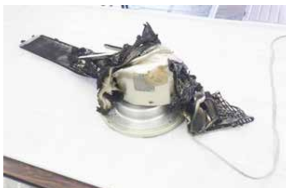
【写真6 焼損品：後カバー側】
