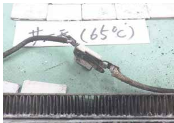
【写真11 焼損品：サーモスタット】
