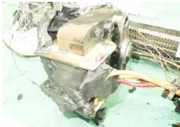
【写真16 焼損品：ファンモーター】
