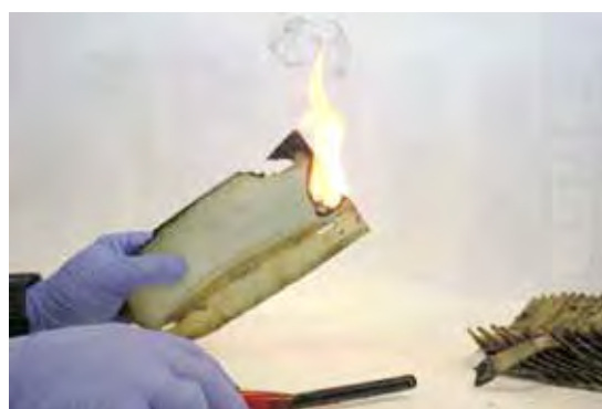
(写真21) 蒸発板の燃焼状況
