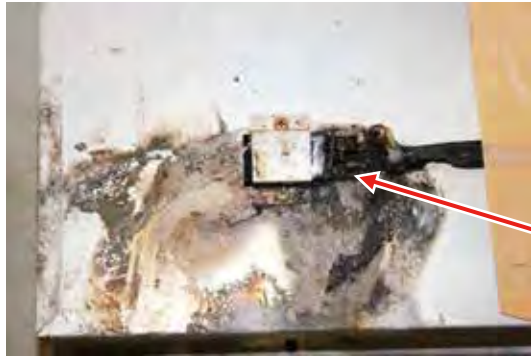
(写真14) 蒸発皿2段目(ヒータ抑え)底面の状況
