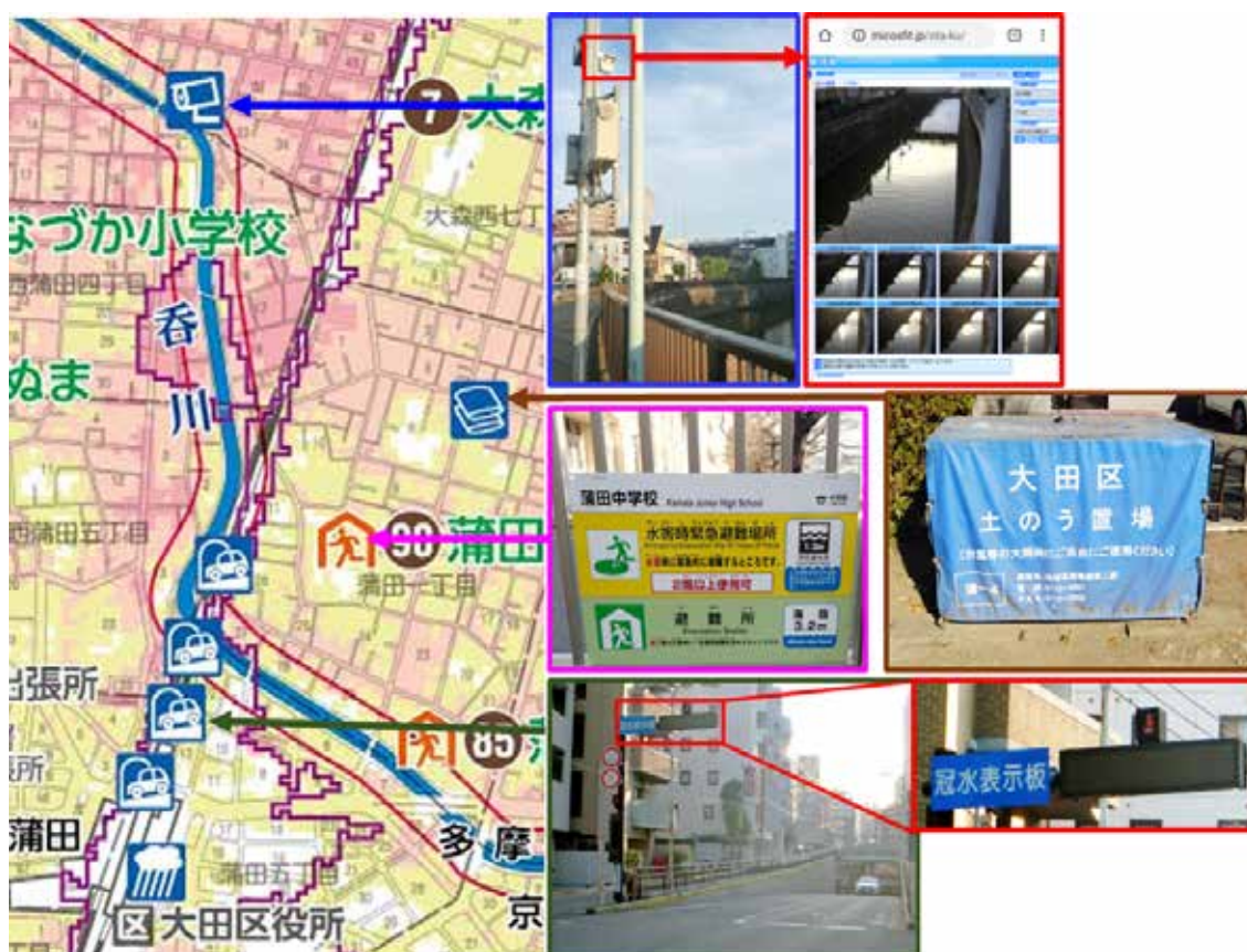
図3 図2の部分的拡大図と現地の写真 （ギザギザの線は、大森川が氾濫した場合の浸水区域の境界。）
