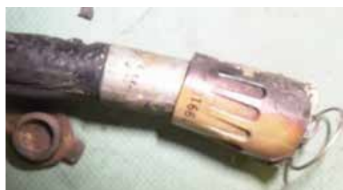
写真19 ガスコード破損部分
