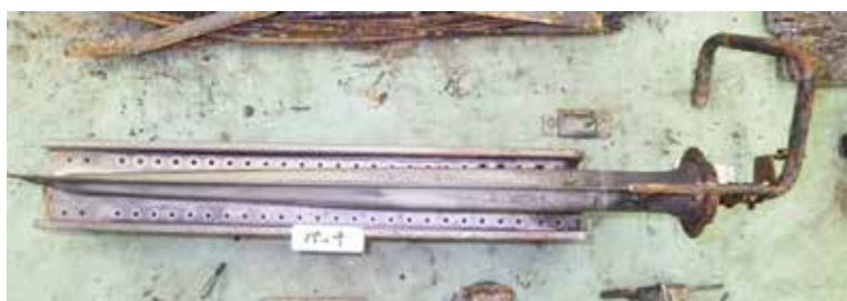
写真13 バーナー及びバーナー内部
