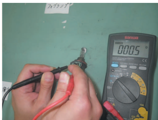
写真18 バルブ導通状態
