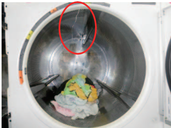
写真9 ドラム内中央の熱電対
