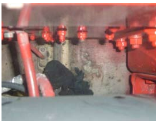
写真7 排気管上の炭化タオル（再現）
