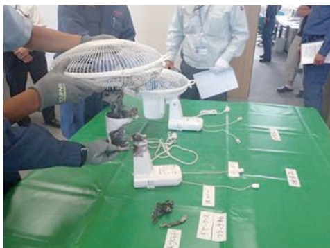
モーターカバーの焼損状況
