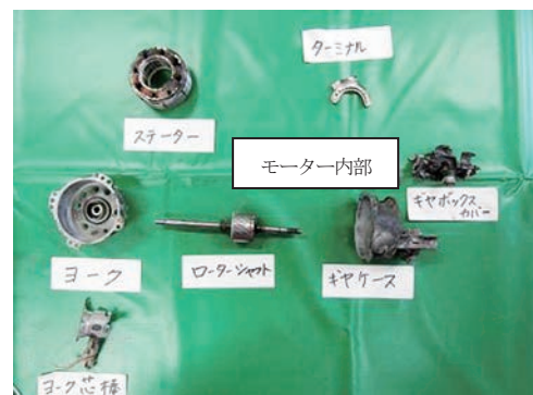
モーター内部の焼損状況
