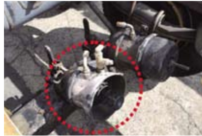
写真2 破損したスプリングチャンバー
