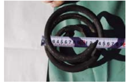
写真3 スプリング欠損状況
